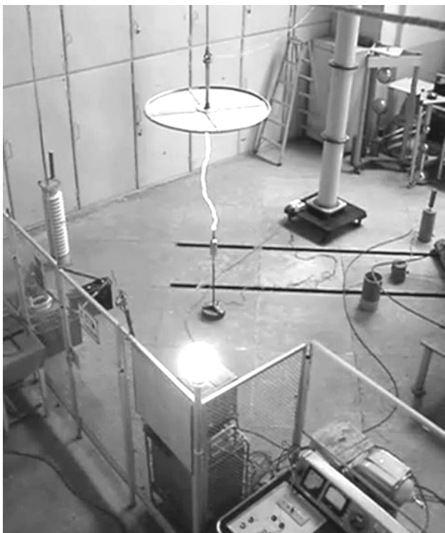
Рис. 9. Общий вид длинной сильноточной искры в случае электрического пробоя рабочего воздушного промежутка длиной 1,19 м испытываемого ОИ (пассивного стержневого молниеотвода) при напряжении среза для коммутационной волны 250/5000 мкс, равном при T_C = 236 мкс согласно данным осциллограммы на рис. 8 около U_{CP} = -690 кВ
